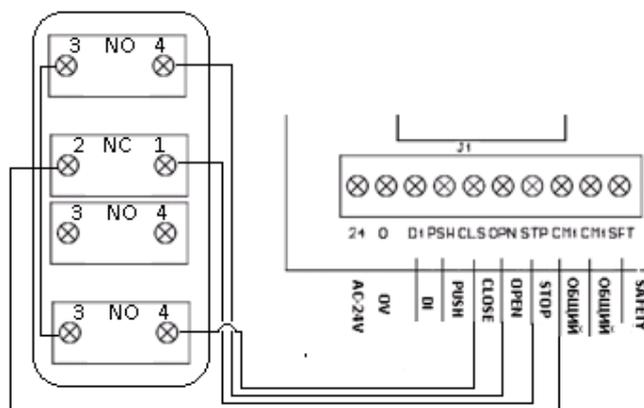
Рис.9 Подключение поста управления
