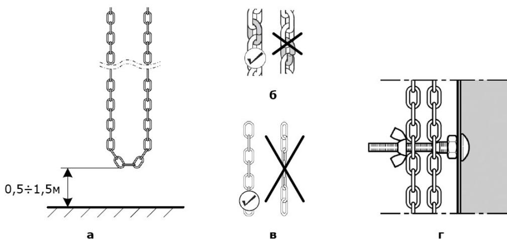
Рис. 4. Условия правильного функционирования цепи ручного управления
