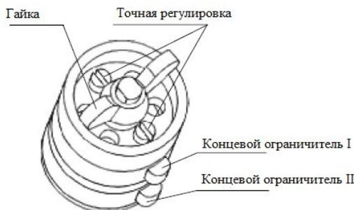
Рис. 7. Планетарный механизм концевых выключателей
