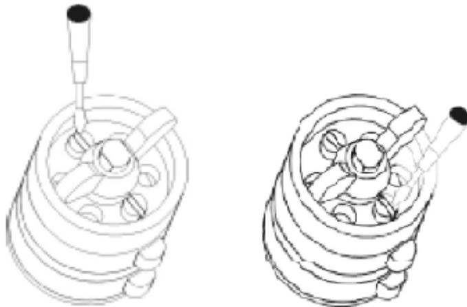
Рис. 8. Регулировка концевых выключателей
